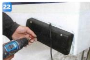
22 Dra dit frontkåpan. Den ska inte dras särskilt hårt (5 Nm).
