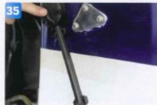
35 Kolla att det stämmer med kabelhöljets. Märk ut fästhålerna för det och skyddslocket till kabelgenomföringen.
