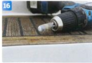
En rasp (fräs) för bormaskinen är ett väldigt användbart verktyg vid alla former av håltagning.
