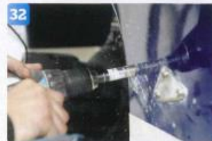
32 Borra hålet för genomföringen med hålsåg Ø19 millimeter.
