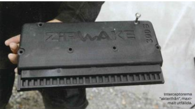
"Framsidan" av interceptorena, alltså den sida som möter vattenströmmen.
