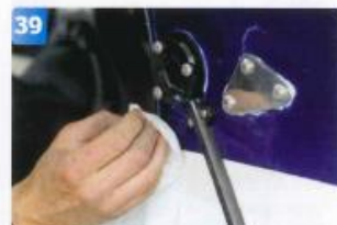
39 Skruva i skruvarna och tvätta med T-röd.
