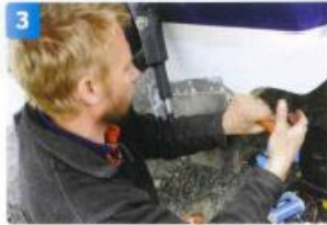
Skruvorna till de gamla trimplanen lossas och sedan kan trimplanen och cylindrarna relativt enkelt bändas loss.
