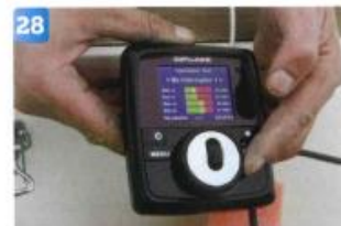
28 Efter testet visas hur interceptorena har presterat i mNm, alltså om de kärvar. De kan till exempel kärva om de dragits skeva vid monteringen, då hamnar de på rätt och måste monteras om.
