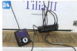
24 Koppla ihop styrenheten med panelen och interceptorena och strömsätt för att kunna testa.
