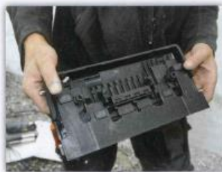
"Framsidan" av interceptorena, alltså den sida som möter vattenströmmen.
