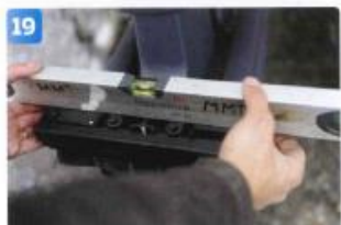
19 Kontrollera att interceptorena är helt raka. glutfel förekommer, även om de är ovanliga.
