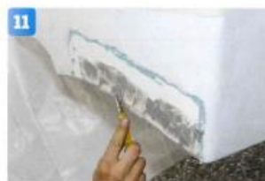
Spackla igen hålen och jämna ut eventuella ojämnheter på akterspejeln.
