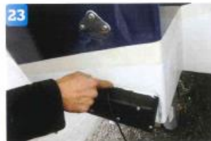
23 Dra ut tätningsmassa längs hela kanten på interceptorn.
