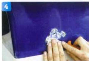
Fästplatsen för trimplanscylindrarna skärs rent från gammal tätningsmassa ...
