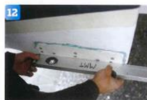
Kolla att akterspejeln har en slät yta för interceptorn, det får inte skilja mer än 2 millimeter längs interceptorns bredd.
