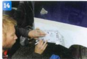
Markera hålen. Obs! Ska du ha sladdgenomföringen under vattenlinjen ska du markera det hålet nu. Säkrast är dock att ha den ovanför vattenlinjen, som vi väljer att göra här.
